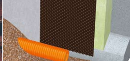
Integriertes Geotextil sorgt für zuverlässige Wasserableitung.
